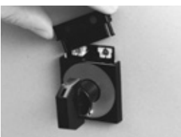
①LED側フランジをパネル表面、上側に斜めにスライドさせながら摘み上げます。
