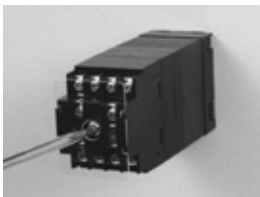
①スイッチ裏面の中央のねじをマイナストライバーで緩めます。
