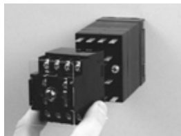
②後方に軽く引っ張ることで取り外すことができます。 (取り付け時の固定用ねじ適正締付けトルクは0.5N・mになります)
