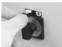
②交換前のLEDを専用工具で軽く摘み、手前へ引き抜きます。
