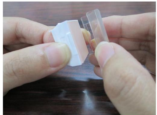
3. 拡散フィルターとレンズの間にあるフィルムを取り除いて下さい。
