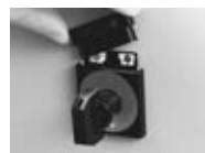
④LED側のフランジをパネル表面、上側より斜めにスライドさせながら取り付けます。
