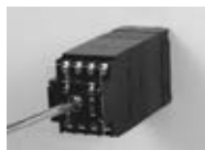
①スイッチ裏面の中央のねじをマイナスドライバーで緩めます。
