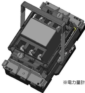
※電力量計、操作レバー取付状態図
